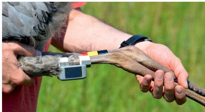
1 pav. Tyrimui naudoti saulės energija įkraunami GPS GSM siųstuvai ir unikaliųjų derinių spalvoti plastikiniai žiedai © Mindaugas Dagys ir Aleksej Peržu
